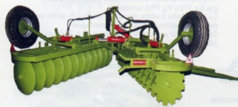
ERPICI FRANGIZOLLE A DISCHI TRAINATI 2 sezioni "V" serie "PMPPTL" (pesante) con trasporto longitudinale Adatto per la lavorazione su sodi e terreni particolarmente compatti. È vantaggioso per il sistema di trasporto longitudinale. Disponibile di serie: nelle versioni da 20 a 28 dischi (da Kg 1.400 a Kg 1.900) zavorrabili.
