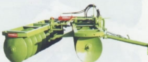
ERPICI FRANGIZOLLE A DISCHI TRAINATI a 2 sezioni "V" serie PML (leggera) e serie PMM (media) La serie Leggera è adatta per terreni sciolti, di medio impasto, maggesi, ed interfilari di piantagioni, e rifinitura pre-semina. Disponibile di serie: nelle versioni da 16 a 28 dischi (da Kg 570 a Kg 990) zavorrabili. La serie Media è adatta per terreni sciolti e di medio impasto, per campo aperto, ed interfilari di piantagioni. Disponibile di serie: nelle versioni da 16 a 28 dischi (da Kg 625 a Kg 1.050) zavorrabili.
