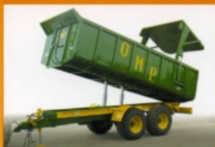
CENTINA ELEVABILE IDRAULICAMENTE FINO A CM 140
