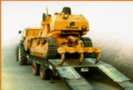
CENTINA ELEVABILE IDRAULICAMENTE FINO A CM 140
